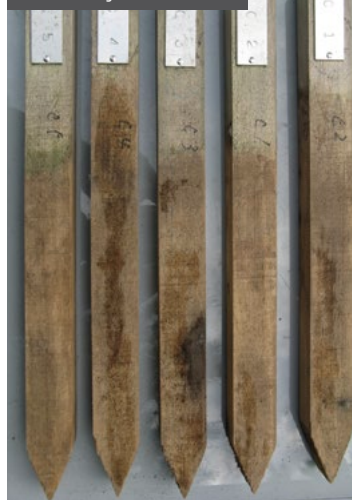
Suché zkušební stanoviště dřeva Accoya®
