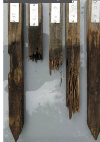
Suché zkušební stanoviště jiného dřeva než Accoya®
