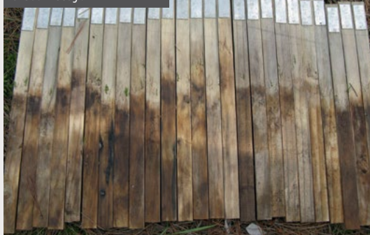
Vlhké zkušební stanoviště dřeva Accoya®
