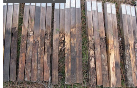
Vlhké zkušební stanoviště jiného dřeva než Accoya®
