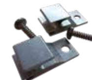
Materiál: HLINÍK Rozměr: 42 x 19 x 15 mm Spona pro neviditelný spoj. Spotřeba cca 30 ks na 1 m².
